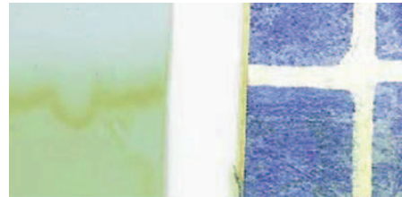
Liners som har kommit i kontakt med solskyddskräm och klorerat vatten som innehåller koppar.
