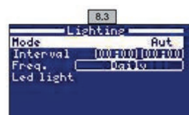
8.3 Automatiskt läge: Ställer in PÅ-/AV- tiderna för lamporna. Dessa timer kan konfigureras med följande frekvenser: dagligen, varannan dag, var 3:e dag, var 4:e dag, var 5:e dag, varje vecka, varannan vecka, var 3:e vecka, var 4:e vecka
